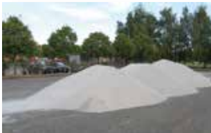
150 Tonnen feiner, sehr runder Quarzsand wurden auf dem Parkplatz zwischen gelagert. Er gibt dem Rasen Festigkeit
