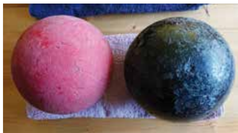
links: die neue Kugel nach ca. 1000 Wurf, rechts eine bisherige Kunststoffkugel nach 150 Wurf
